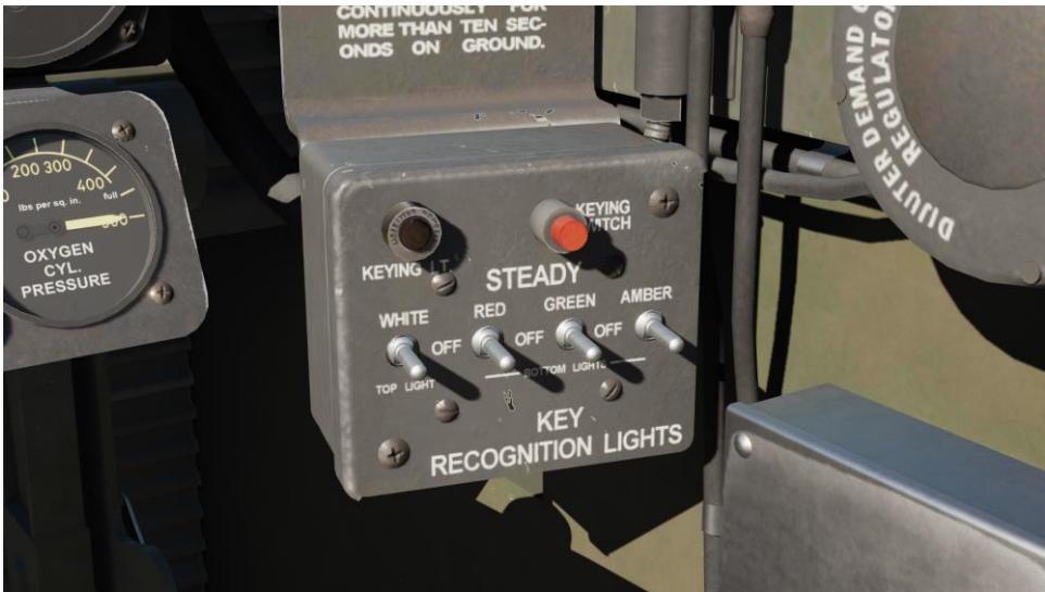
Abbildung 75. Schaltkasten für Erkennungsleuchten
