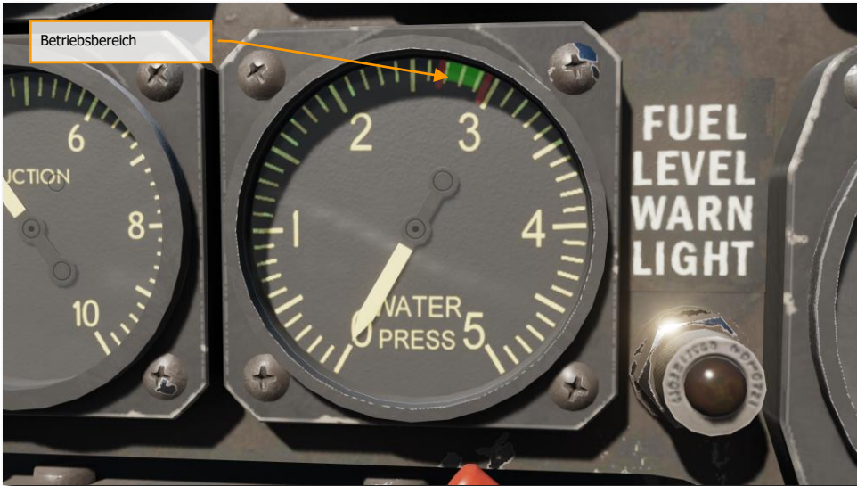
Abbildung 91. Betriebsbereich für Wasserdruck ist 25 - 27 PSI
