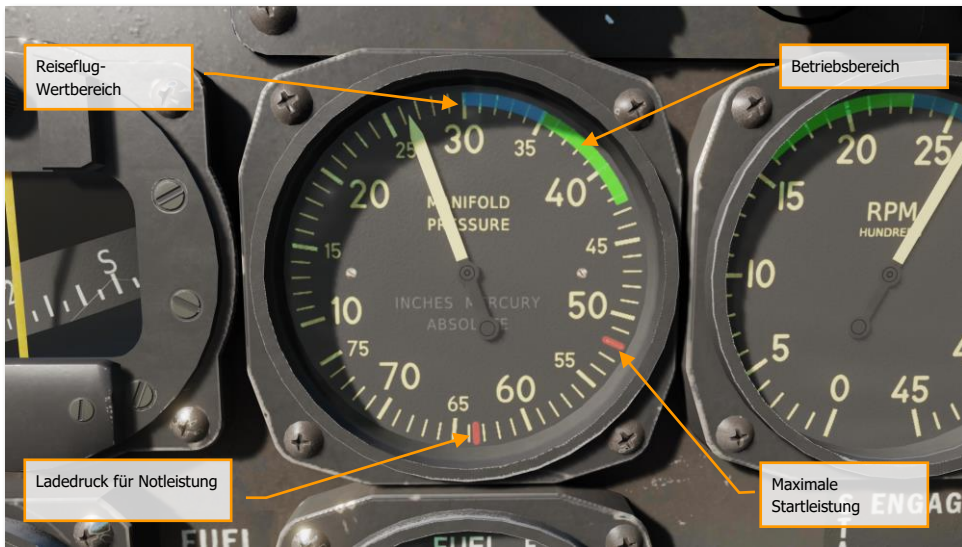
Abbildung 85. Ladedruck-Anzeiger
