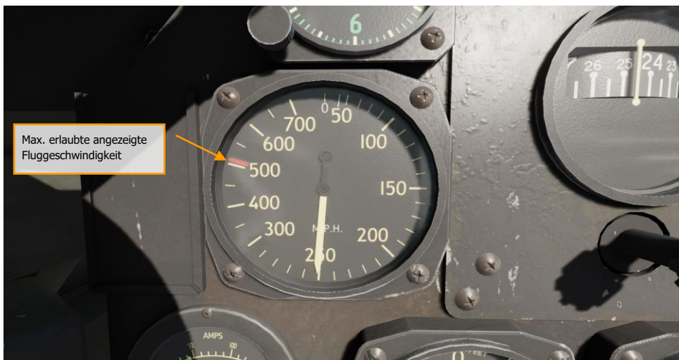
Abbildung 88. Maximal erlaubte angezeigte Fluggeschwindigkeit ist 505 mph
