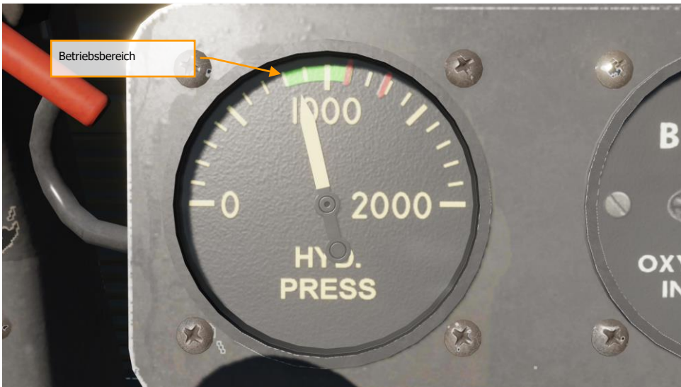
Abbildung 92. Betriebsbereich Hydraulikdruck ist 800 – 1.100 PSI. Max. Hydraulikdruck – 1.300 PSI
